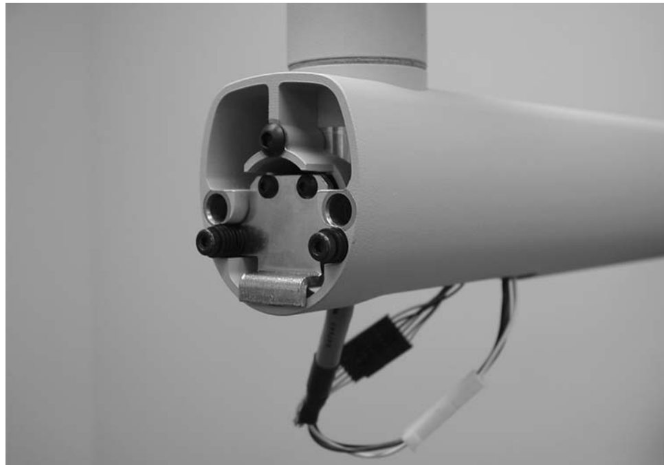
Рисунок 20 Подключение кабелей подвижного и горизонтального плеч
