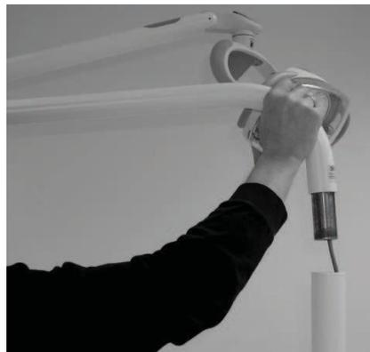
7.- Подключите кабель лампы к разъему внутри гидроблока (см. соответствующую схему)
