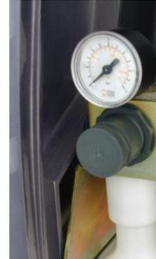
Наблюдайте за манометром внутри гидроблока. Давление должно составлять примерно 2 кг/см<sup>2</sup>. При необходимости отрегулируйте клапан согласно информации в разделе по регулировке давления.
