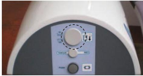
Переключатель «Вкл/Выкл» на водонагревателе.
