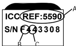
(A) Номер REF представляет собой номер модели. (B) Первая буква серийного номера соответствует месяцу выпуска изделия. (C) Первая цифра серийного номера обозначает год выпуска. Например, 4 - 2004 г.
