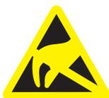
Запрещается касаться штифтов или гнезд штекеров, оснащенных предупреждающей табличкой об электростатическом разряде, без применения мер по предотвращению электростатического разряда, а также выполнять соединения между подобными штекерами. См. также раздел „Электростатический разряд“ и „Электромагнитная совместимость“.
